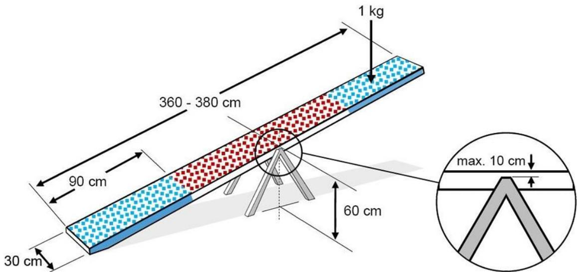
Рисунок 128. Конструкция препятствия «качели»
