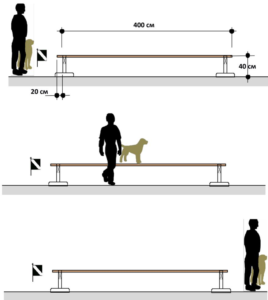
Рисунок 73. Жесткозакрепленная доска
