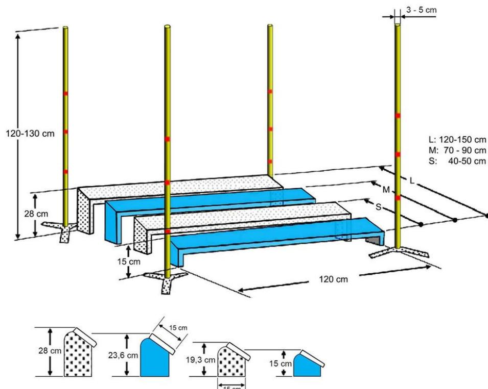
Рисунок 133. Конструкция препятствия «прыжок в длину»
