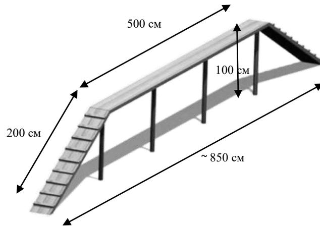
Рисунок 60. Схема препятствия «бум»
