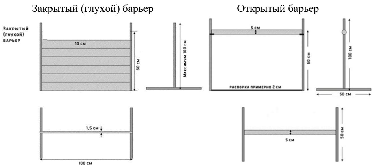
Рисунок 20. Конструкции барьеров
