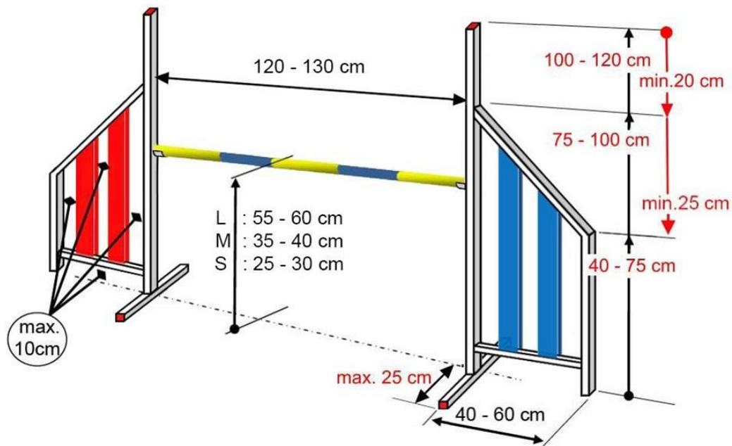
Рисунок 124. Конструкция препятствия «одинарный барьер»
