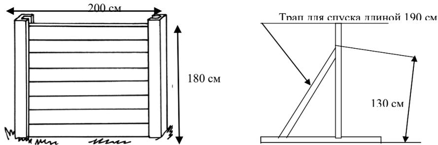
Рисунок 57. Схема препятствия «глухой забор»
