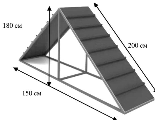
Рисунок 58. Схема препятствия «горка»
