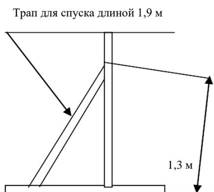
*Наклонная стенка:* высота – 1,6 (1,4) м, ширина – 1,5 м. Состоит из двух щитов шириной 1,5 м и высотой 2 м, скрепленных между собой. Щиты должны иметь поперечные планки сечением 20 x 15 миллиметра на расстоянии 0,2 м друг от друга, начиная сверху.
