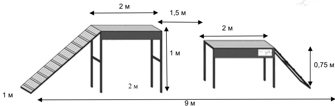
**Бум:** препятствие состоит из бревна длиной 5 м с плоским верхом и двух трапов, высота над землей 1 м, ширина плоской части бревна и трапов 0,20–0,30 м. На верхнюю поверхность трапов набивают поперечные бруски сечением  $3 \times 1,5$  см на расстоянии 0,2 м один от другого, начиная сверху.
