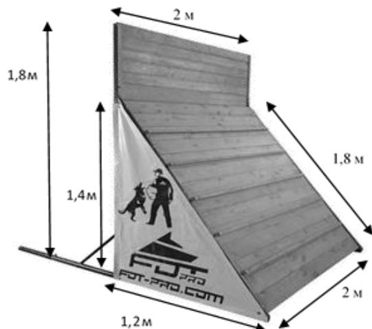
**Горка:** высота — 1,6 м, ширина — 1,5 м. Состоит из двух щитов шириной 1,5 м и высотой 2 м, скрепленных между собой. Щиты должны иметь поперечные планки сечением 20 × 15 мм на расстоянии 0,2 м друг от друга, начиная сверху.
